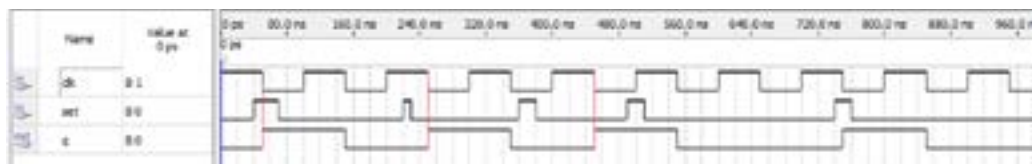
Figura 2.6. Simulación del circuito activo con el flanco de bajada
